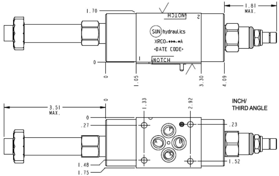
Cet ensemble assure 2 fonctions : Il limite la pression en dérivant du débit de l'orifice 1 vers le réservoir (orifice 2) lorsque la pression à l'orifice 1 excède le tarage de la valve. Et l'électrovalve permet de mettre le circuit à vide, ce qui fait chuter la pression au niveau minimum. Cet ensemble peut être normalement ouvert, ce qui signifie que la pression est minimum tant que l'électrovalve n'est pas excitée, ou il peut être normalement fermé, et dans ce cas
